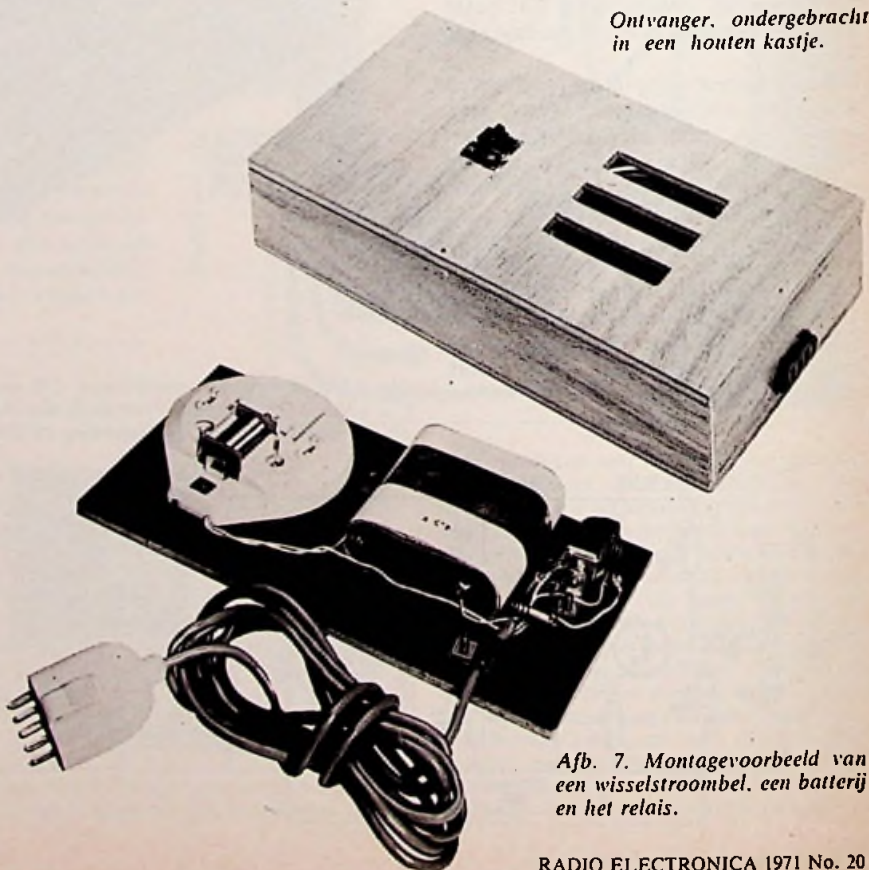
Fig. 5. Voor de bekrachtiging van een wisselstroom bel wordt eveneens een relais op de uitgang van fig. 1 aangesloten.
